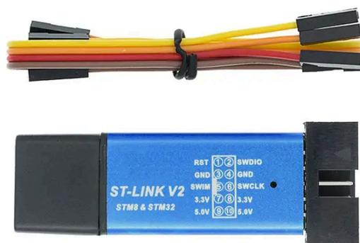
Programador e depurador ST-LINK V2
