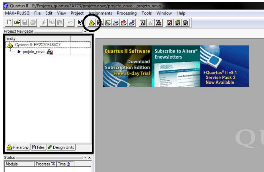
Figura 7: Botão em destaque habilita a hierarquia de projeto. A árvore que representa todos os módulos que compõem o projeto também está destacado.
