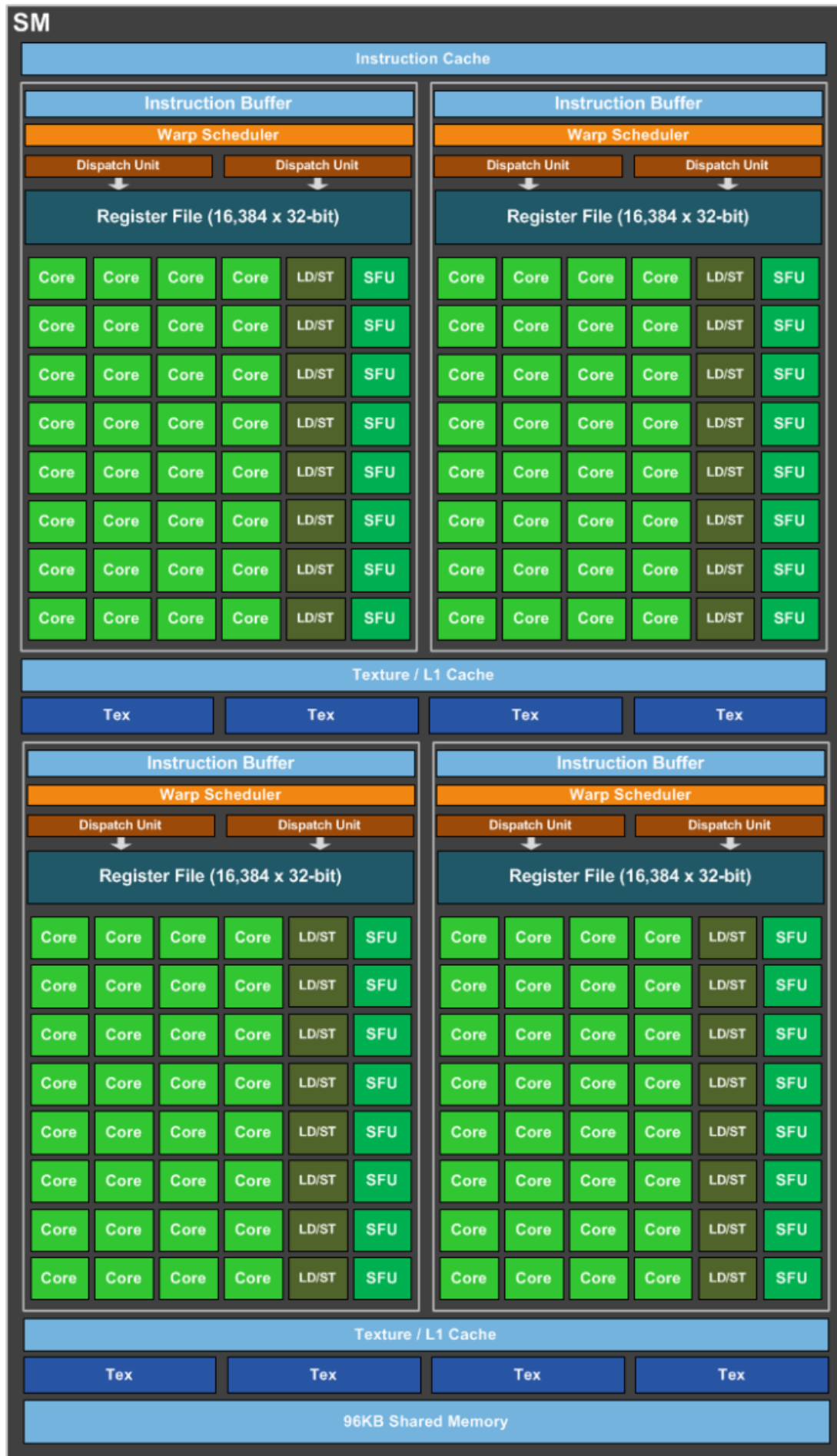
Figura 29 – Arquitetura de um SM num chip Pascal (NVIDIA, 2016)
