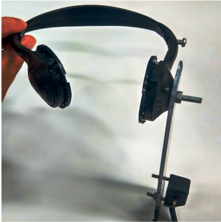
Figura 74 – Estrutura de fixação do transmissor do digitalizador Fastrak Polhemus® na cabeça do sujeito de teste.
