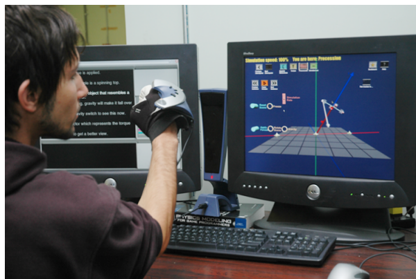
Figura 2.4: Sistema LEMMA sendo utilizado com dois monitores como dispositivo de saída e uma Data Glove como dispositivo de entrada de dados.
