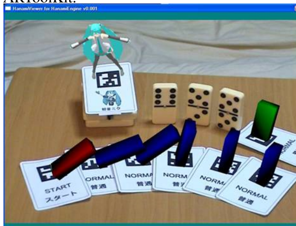
Figura 2.5: Imagem gerada pela composição do vídeo de uma câmera com a sobreposição de modelos 3D utilizando a biblioteca ARToolKit.
